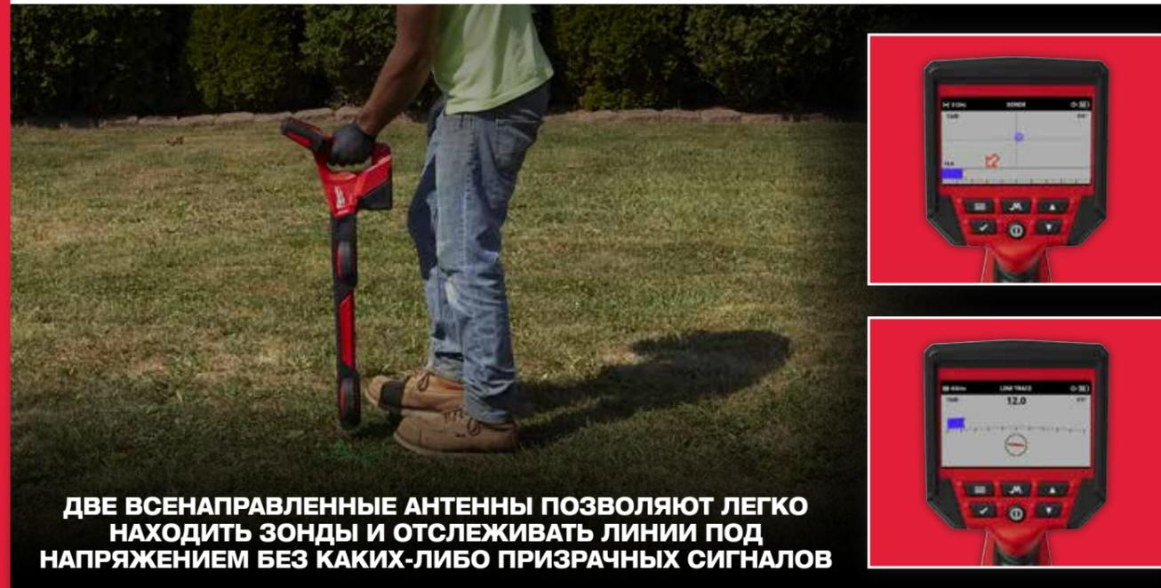
**ДВЕ ВСЕНАПРАВЛЕННЫЕ АНТЕННЫ ПОЗВОЛЯЮТ ЛЕГКО НАХОДИТЬ ЗОНДЫ И ОТСЛЕЖИВАТЬ ЛИНИИ ПОД НАПРЯЖЕНИЕМ БЕЗ КАКИХ-ЛИБО ПРИЗРАЧНЫХ СИГНАЛОВ**
